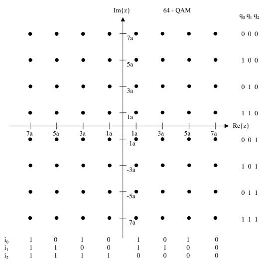
Bit ordering:  $\{i_0 i_1 i_2 q_0 q_1 q_2\} = \{y'_0 y'_1 y'_2 y'_3 y'_4 y'_5\}$
