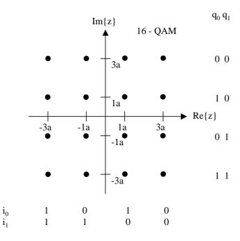
Bit ordering:  $\{i_0 i_1 q_0 q_1\} = \{y'_0 y'_1 y'_2 y'_3\}$
