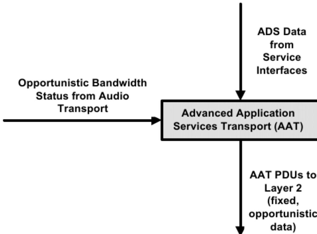
O encapsulamento dos dados do AAT em pacotes segue um enquadramento semelhante ao HDLC (High-Level Data Link Control) utilizado pelo PPP (Point-to-Point Protocol), definido pela IETF na RFC-1662 ("PPP in HDLC-Like Framing").
